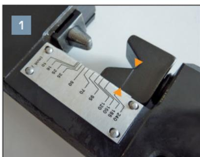
Ajustar la sección deseada con el tornillo, haciendo que la marca coincida.
