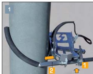
Desbloquear la grapa (1) y ajustar el arco regulable (2) al diámetro inicial del poste hasta que el trepador quede en posición horizontal.
