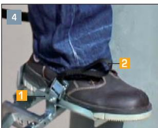
Colocar el pie en la base (1) y ajustar la hebilla (2) a la bota tirando de la correa de nylon.
