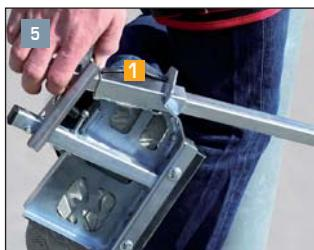
A medida que el diámetro del poste vaya cambiando en el ascenso o descenso, se debe ir regulando el arco de sujeción (1) a las nuevas medidas para conseguir un máximo agarre.
