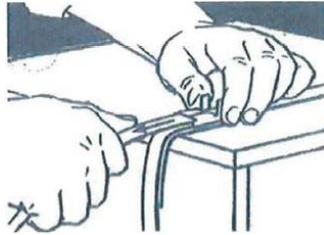
6 - Sujetar la herramienta con firmeza. La ranura del tensor debe estar alineada con la ranura de la cabeza de corte.
