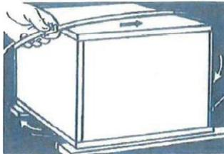
3 - Volver a introducir el fleje en la chapa por debajo del fleje inicialmente introducido durante la etapa nº 1. El fleje debe sobrepasar de unos 5 cm después de la chapa.
