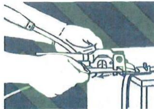
8 - Posicionar el fleje completamente a la izquierda donde están las cuchillas para garantizar un corte correcto. Idealmente, la parte derecha del fleje no debe quedar fuera de la herramienta. Empezar a tensar el fleje con la palanca de tensión (palanca izquierda) sujetando firmemente la palanca de corte (palanca derecha).
