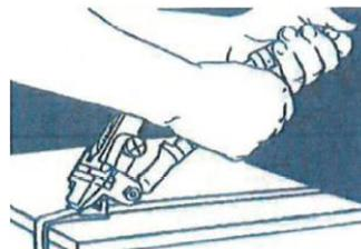
13 - Empujar la palanca de corte para cortar el fleje.
