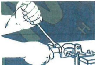
11 - Empujar manualmente las dos palancas hacia adelante para bloquear el fleje en la chapa.
