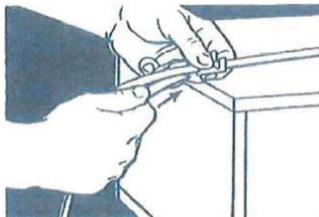
4 - Plegar completamente los 5 cm de fleje por debajo de la chapa (manualmente o con un martillo).
