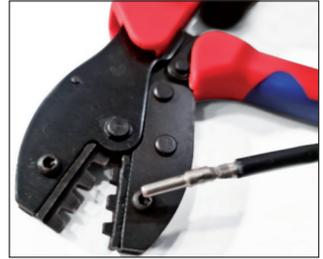
Utilice la herramienta de crimpado adecuada. Coloque el contacto de metal en la cavidad apropiada de la herramienta manual según la sección del cable (la parte abierta del contacto metálico tiene que mirar hacia arriba). Inserte el cable en el contacto y presione la herramienta hasta final. Asegúrese de que no haya bordes afilados, ni daños después del crimpado.
