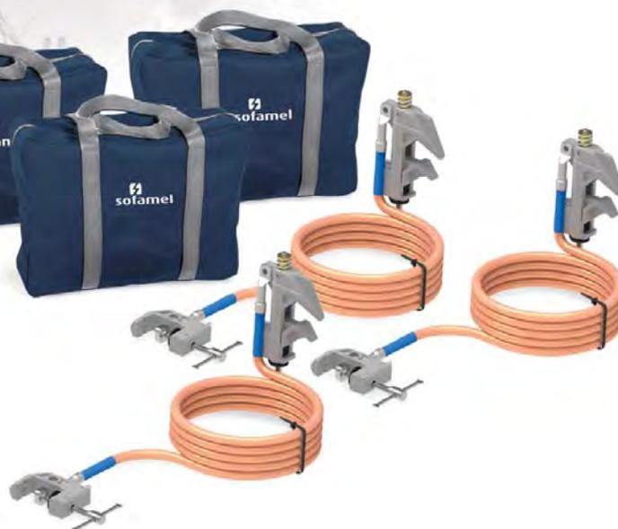
Las pinzas se pueden fijar a los conductores cilíndricos, pletinas o barras de distribución flexibles o puntos de fijación mediante apriete por tornillo. Intensidad de cortocircuito 31,5 kA (Cable 120 mm<sup>2</sup>).
