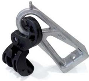
El conjunto de suspensión ES-1500 está compuesto por una consola en aleación de aluminio y una pinza de suspensión con pala de fijación móvil en material plástico reforzado. Diseñado para facilitar la instalación y garantizar una sujeción segura de acometidas aéreas.
