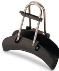
Consola fabricada en material termoplástico de alta resistencia, diseñada para la sujeción de acometidas en los puntos de suspensión o cambio de dirección. La anilla de acero inoxidable permite una fijación segura del conductor.
