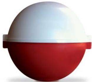
Balise de signalisation diurne conçue pour avertir les aéronefs de la présence de câbles et prévenir les accidents. Fabriquée en polyéthylène renforcé de fibres de verre, elle offre une haute résistance aux rayons UV ainsi qu'aux conditions climatiques extrêmes. Conçue avec un profil aérodynamique, elle est équipée d'accessoires permettant un montage et un réglage rapides. Elle peut être installée sur des câbles sous tension, des câbles de garde et des câbles à fibres optiques.
