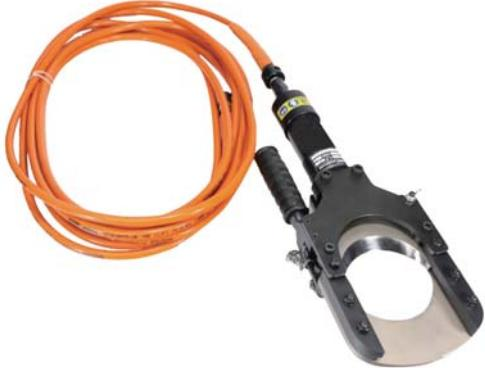
La testa di taglio CT-120M è adatta per tagliare cavi in tensione che potrebbero essere accidentalmente energizzati (fino a 220 kV), al fine di prevenire incidenti durante i lavori di riparazione e manutenzione. È equipaggiata con un tubo flessibile ad alta capacità dielettrica di 10 metri di lunghezza.
