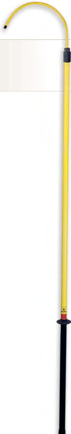
Fioretto di recupero personale costituito da un solo elemento tubolare di poliestere e fibra di vetro Ø 32 mm dotato di guarnizione sigillante alle due estremità, paramano, impugnatura, punta, testa M-10 e gancio di recupero.
