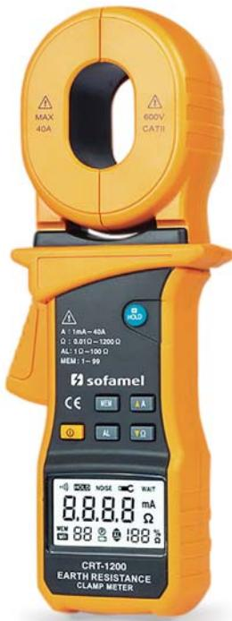
La pinza amperometrica è in grado di eseguire misurazioni di resistenza di messa a terra in posti di difficile accesso, anche al chiuso o interamente pavimentati dove non è possibile usare puntali o altre attrezzature ausiliarie. La rilevazione avviene in modo molto semplice senza bisogno di scolare e ricollegare l'impianto di messa a terra. Questo tester è principalmente utilizzato nel campo della distribuzione di elettricità, telecomunicazioni, edilizia ed elettronica industriale.
