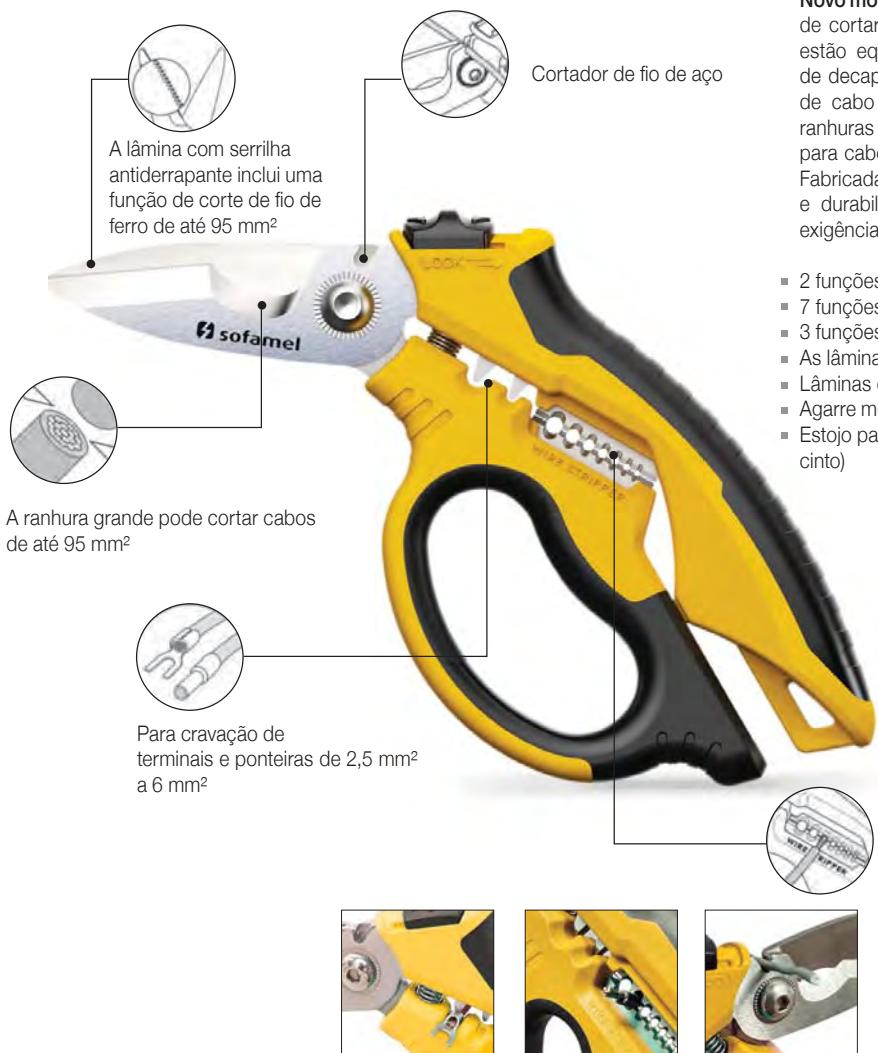
**Novo modelo de tesouras profissionais:** capazes de cortar cabos de até 95 mm<sup>2</sup>. Estas tesouras estão equipadas com uma conveniente função de decapagem de fio compatível com tamanhos de cabo que vão de 0,34 mm<sup>2</sup> a 6 mm<sup>2</sup> nas ranhuras entre os cabos. Função de decapagem para cabos de maior seção na ranhura de corte. Fabricadas com aço inoxidável de alta qualidade e durabilidade, são projetadas para resistir às exigências do uso diário.
