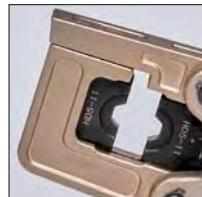
*Ferramenta hidráulica de cravação a bateria*
