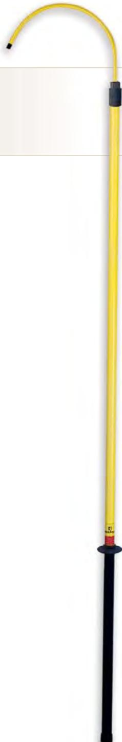
Varas de um único elemento, feitos com tubo de poliéster e fibra de vidro de Ø 32 mm. Com tampões anti-humidade em ambas as extremidades, protetor de mão, empunhadura, base, cabeça métrica M-10 e gancho de salvamento.
