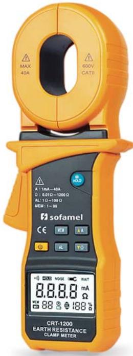
Verifica a aterragem em espaços de difícil acesso, incluindo áreas internas ou completamente pavimentadas onde não são permitidas picadas auxiliares de teste. Identifica a resistência sem a necessidade de desconectar e reconectar a instalação da ligação à terra.
