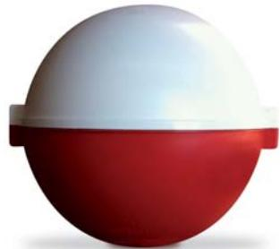
Esfera de sinalização diurna concebida para alertar as aeronaves da presença de cabos e prevenir acidentes. Fabricada em polietileno reforçado com fibra de vidro, apresenta elevada resistência aos raios UV e a condições climáticas extremas. Projetada com um perfil aerodinâmico, está equipada com acessórios que permitem uma montagem e ajuste rápidos. Pode ser instalada em cabos sob tensão, cabos de guarda e cabos de fibra ótica.
